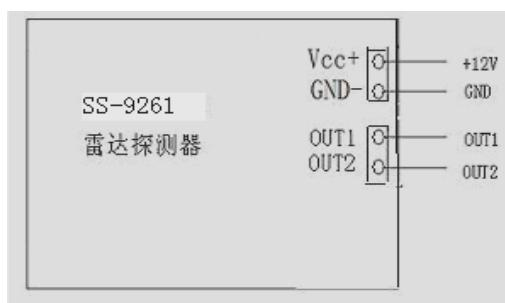
1.4 探测器的接线图如图所示，印制板上设置有灵敏度调节电位器 RP1，可以使监控距离在 0.5~7 米范围内可调，顺时针转动距离变近，逆时针转动距离变远。
