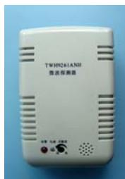
1.2 探测器有两个指示灯，绿色为电源指示灯，绿色灯亮表示输入电源正常，红色发光二极管为告警指示灯，当雷达探测模块检测到人体或者物体移动时，红色发光二极管告警灯亮，还有一个灵敏度调节电位器，调节检测距离，顺时针调近，逆时针调远。
