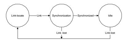
Figure 5-1 : link initialisation algorithm
