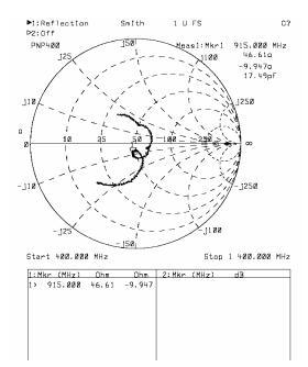
Figure 12. LNA Input Impedance
