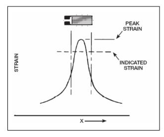
作为一个经验法则, *在实践中*, 对于小孔, 圆角, 凹 槽,或任何其它需要测量的集中应力的结构,应变计栅长 应不大于他们的半径的0.1倍,或相应尺寸。对于尺寸明显 小于0.5 in [13 mm]的集中应力的结构,这一经验法则会导 致选取非常小的应变计。由于选用小应变计可能导致许多 其它问题, 因此往往需要折衷。
