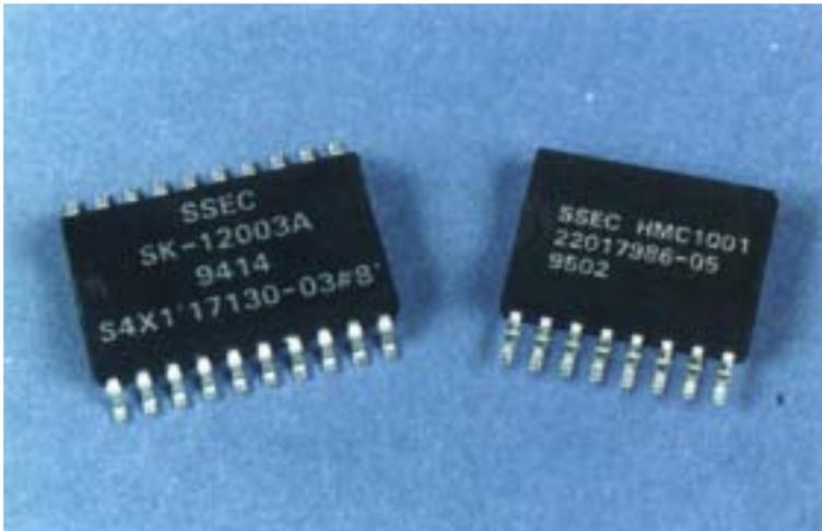
图 7. MR 传感器为异态检测提供高灵敏度和独特的解决方法。根据物体的磁性信号特征支持物体的识别
