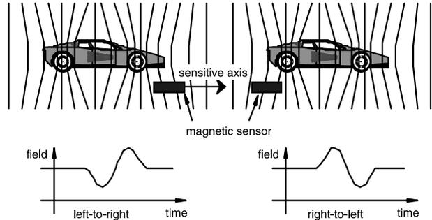
图 11 对于通过传感器车辆的方向检测
