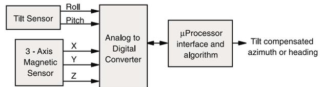
图 18 捷联电子罗盘的功能框图
