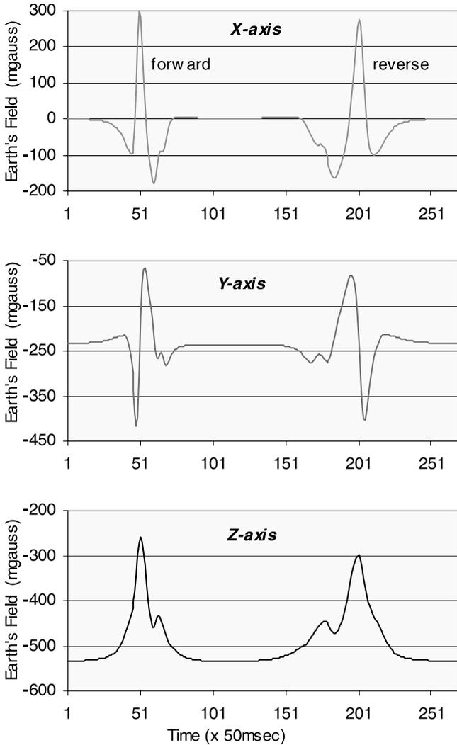
图9 当一辆轿车正向（向南）和倒车（向北）行驶时，X、Y、Z磁场的扰动。传感器距地面1英尺，距车辆1英尺。
