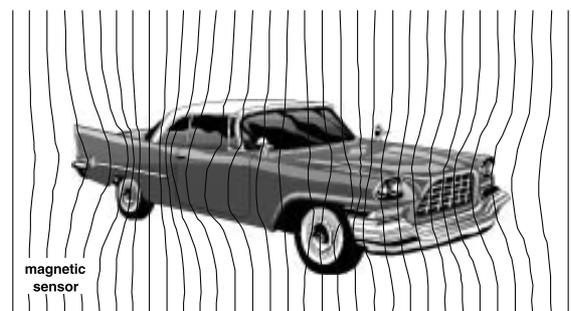
图 4 在地球磁场中车辆的扰动
