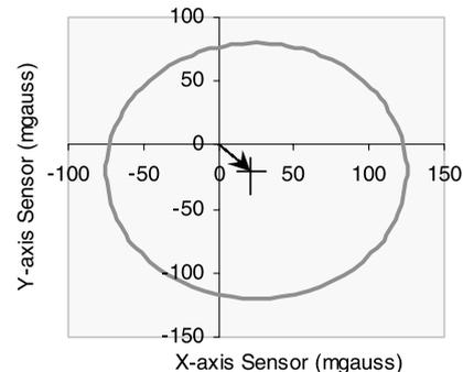
图 20 当在地球磁场下，在水平面内旋转时，X 和 Y 轴的输出显示出硬铁的偏置影响
