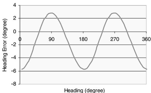
图 22 当在水平面旋转时,因为靠近软铁金属而产生的 X 和 Y 轴的误差。
