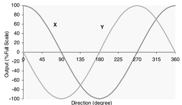
图 15 两个正交的磁传感器在地磁场中，在水平面内作旋转运动，输出为正弦和余弦函数
