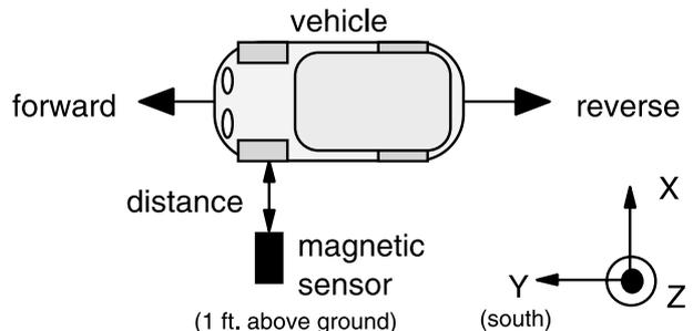
图6 车辆和磁场传感器的方向初始化设置
