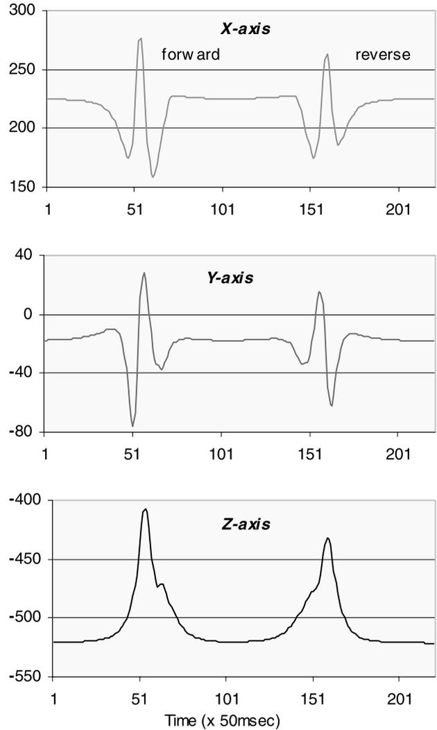
图10 当一辆轿车正向（向西）和倒车（向东）行驶时，X、Y、Z磁场的扰动。传感器距地面1英尺，距车辆3英尺。
