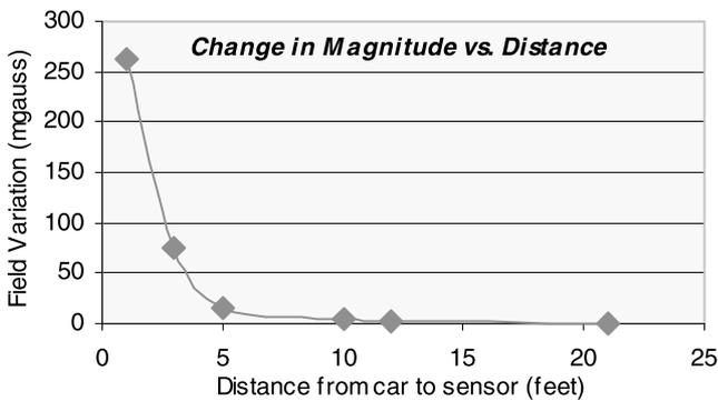
图 13 当车辆距传感器不同距离时，磁场强度数值的变化
