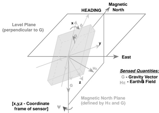
图 19 · 在罗盘坐标系中重力矢量和磁场矢量的说明。
