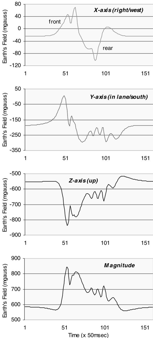
图7 面包车从磁场机上方通过时对地球的扰动。车辆从北向南行驶
