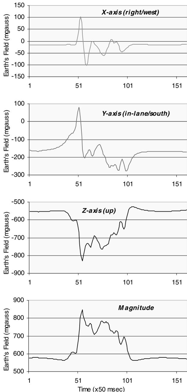
图8 轿车从磁场机上方通过时对地球的扰动。车辆从北向南行驶
