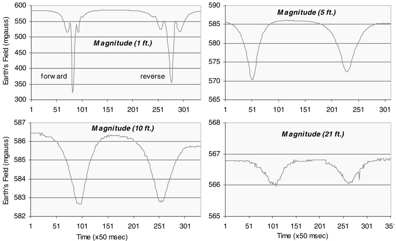
图 12 当车辆距传感器 1、5、10、英尺（南北方向）和 21 英尺（东西方向）正向和倒车行驶时，磁场扰动的数量级
