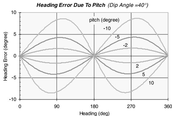
图 17 两轴罗盘随俯仰角的变化，航向误差变化的情况，模拟 40 度磁倾角。
