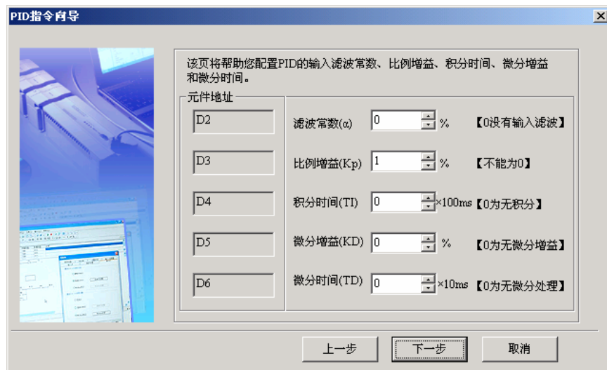
图6-22 滤波常数、比例增益、积分时间、微分增益、微分时间配置界面
