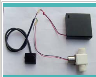
名称: SSD-ME001-1 型号: 水龙头感应模块/洁具感应模块
