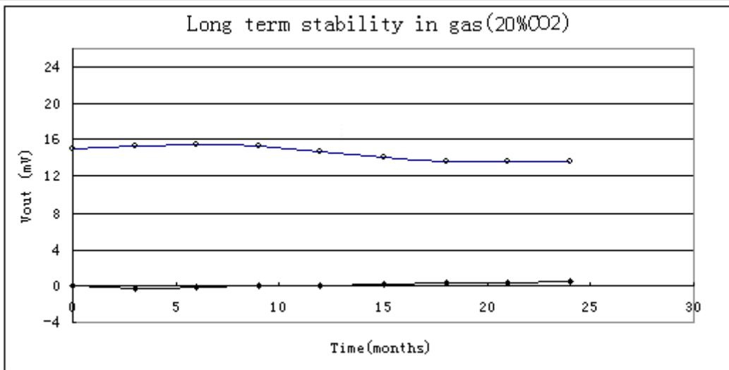
在空气中每年漂移小于 2 个 mV，在 20%CH<sub>4</sub> 中每年漂移小于 2 个 mV。短期储存（两周内）老化 10 小时即可稳定，如长期储存（一年），则需老化 24 小时才可稳定。
