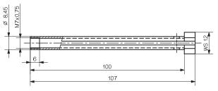
Fig. 9: Extraction tool Typ 1317
