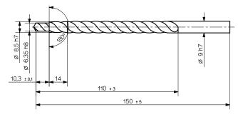
Fig. 8: Step drill Typ 1337A
