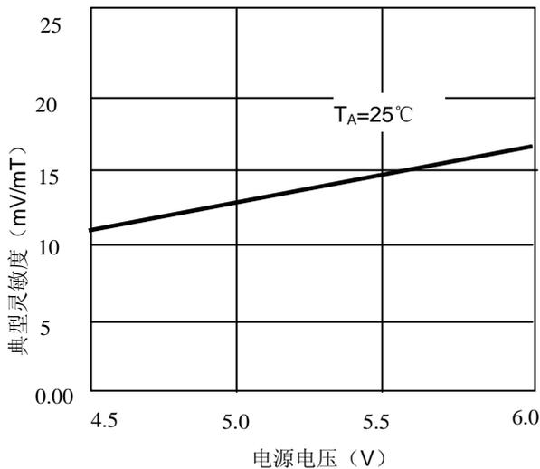
DB3503 典型灵敏度与电源电压关系曲线
