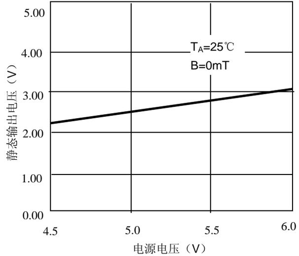
DB3503 静态输出电压于电源电压关系曲线
