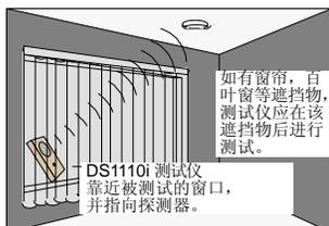
应使用DS1101i玻璃破碎测试仪进行该项测试。DS1101i产生使探测器报警的高频音，以进一步校验适当的安装位置。
