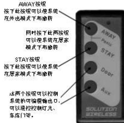
图2: RE013 4 键无线遥控器
