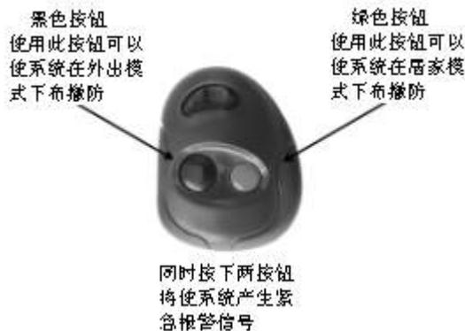
图1: RE012 2 键无线遥控器
